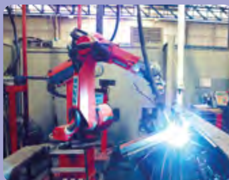
Robot soldadura REIS
